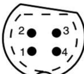
Vue embase mâle Côté câblage
